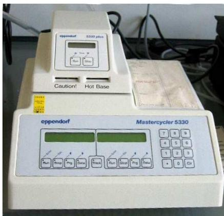
En gros, le test PCR est un ensemble de composants : les écouvillons, le Thermocycleur (le testeur) et des réactifs.
